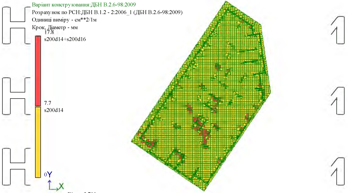
Відм. -3.700 Площа повної арматури на 1пм по осі X біля нижньої грані (балки-стілки - посередині); максимум в елементі 4355
