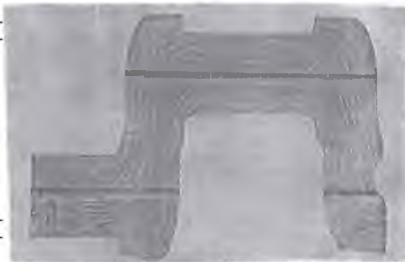
Рис. 2.4 - Волокниста орієнтація структури при деформації
