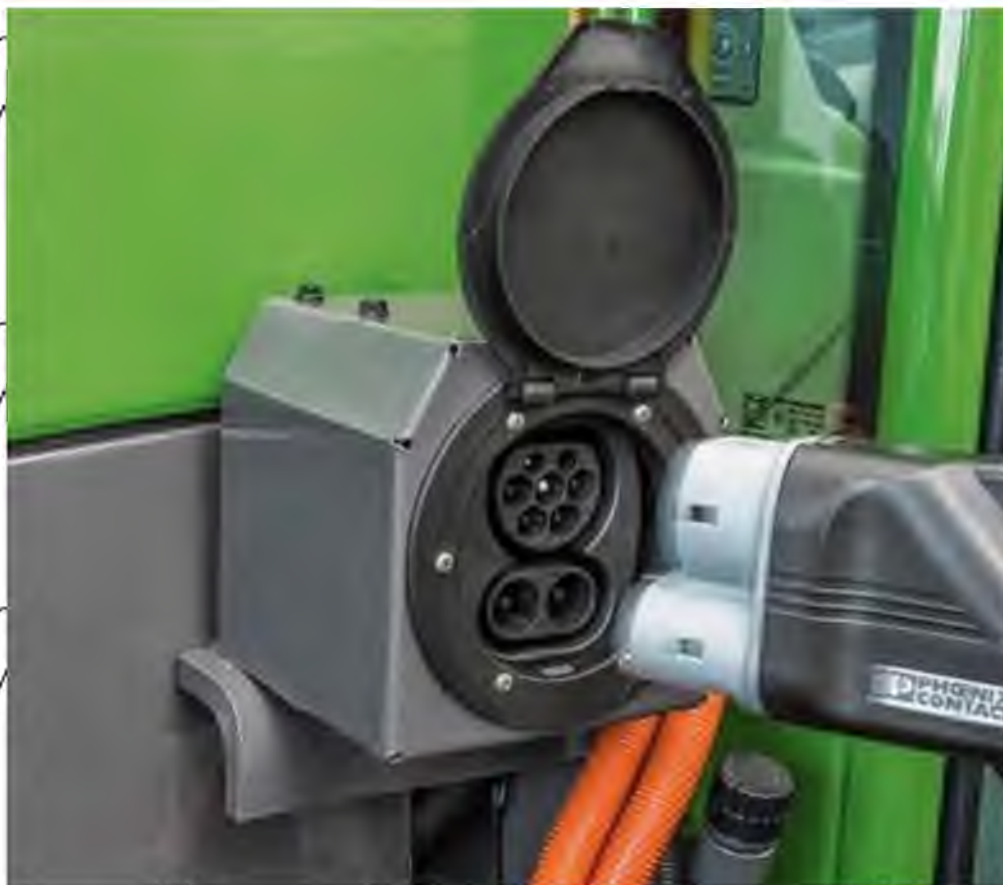
Рис 1.5. Система роз'ємів живлення трактора
