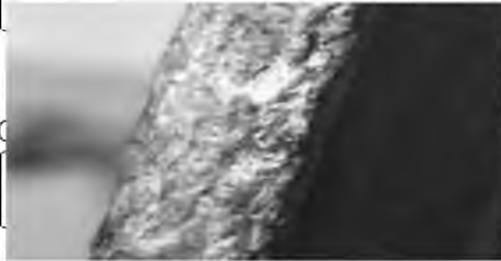
Рисунок 5.2 - Зношена поверхня зварювального ролика установки 011-1-
