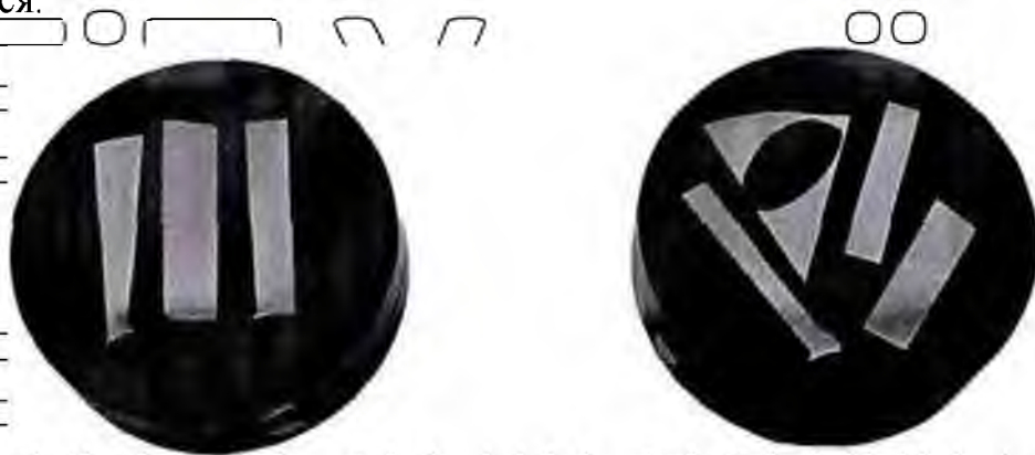
Рисунок 3.4 – Фото підготовлених металографічних зразків
