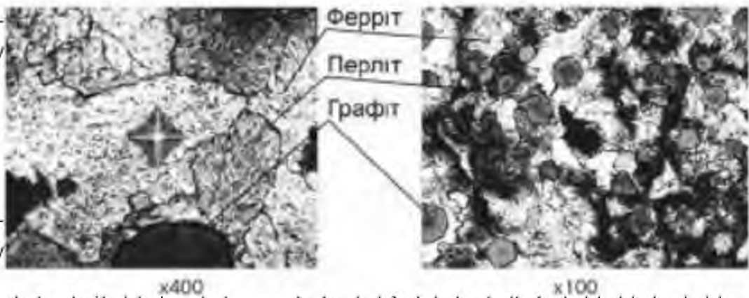
Рисунок 4.4 - Мікроструктура чавуну В450-2 після ЕКПС 50ХФА+ГЧ-СР2
