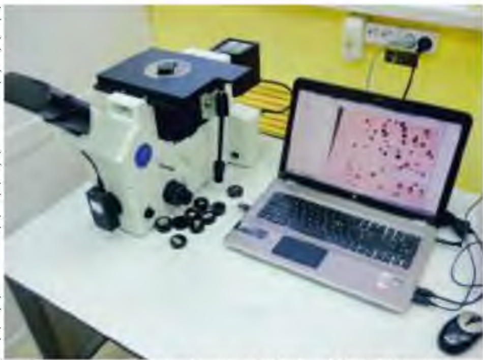
Рисунок 3.5 – Аналізатор фрагментів мікроструктури твердих тіл
