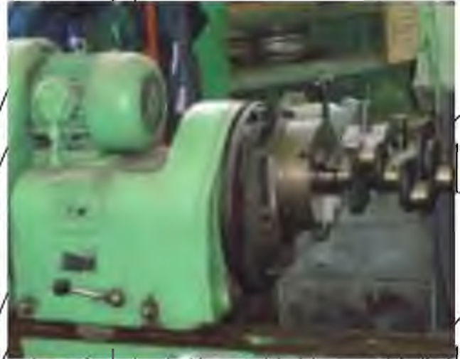
Шліфування шийок колінчастого вала в номінальний або ремонтний розмір
