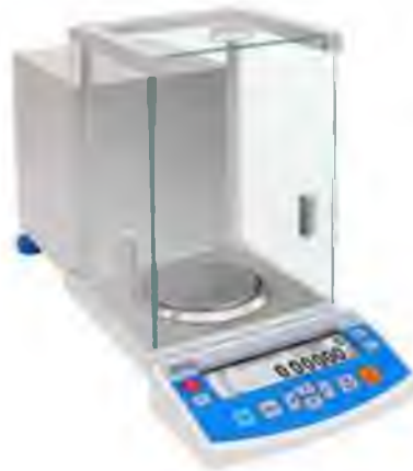
Рисунок 3.22 – Аналітичні ваги вторинності MSU 225S-100-DU Cubis
