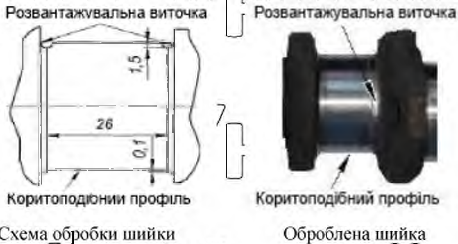
Рисунок 5.1 - Шийка КВ 24-1005011-20 з конструктивно-технологічною підготовкою поверхні
