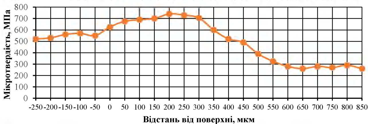
Рисунок 4.7 – Розподіл мікротвердості зразка 50ХФА+ПГ-СР2 - ВЧ50-2
