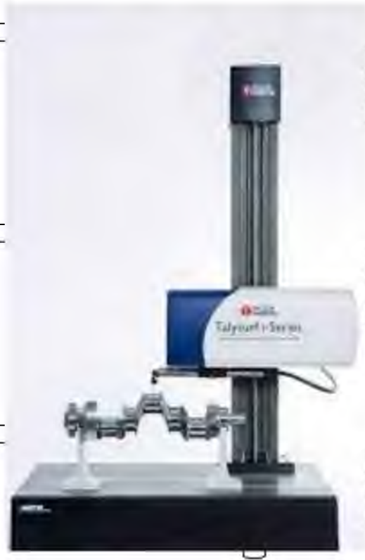
Рисунок 3.17 - Профілограф-профілометр «Form Talysurf il20»
