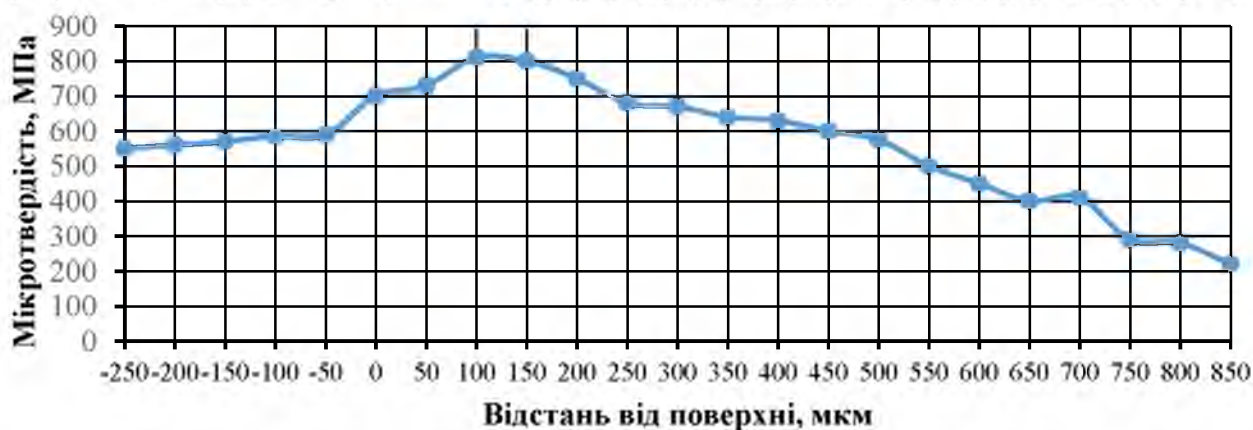
Рисунок 4.6 – Розподіл мікротвердості зразка 50ХФА – ВЧ50-2
