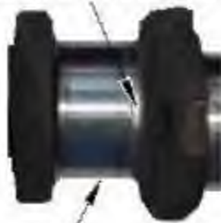
Рисунок 4.20 - Шийка чавунного КВ двигуна ЗМЗ-24, відновленого ЕКПС із
