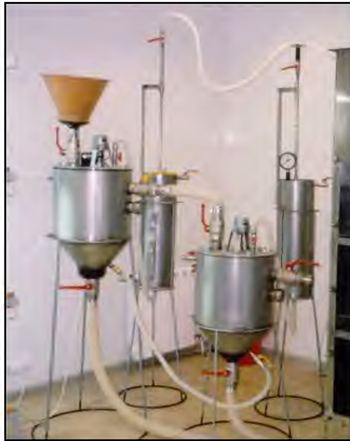
Рис. 2.1 Загальний вигляд дослідної біогазової установки БУ-1
