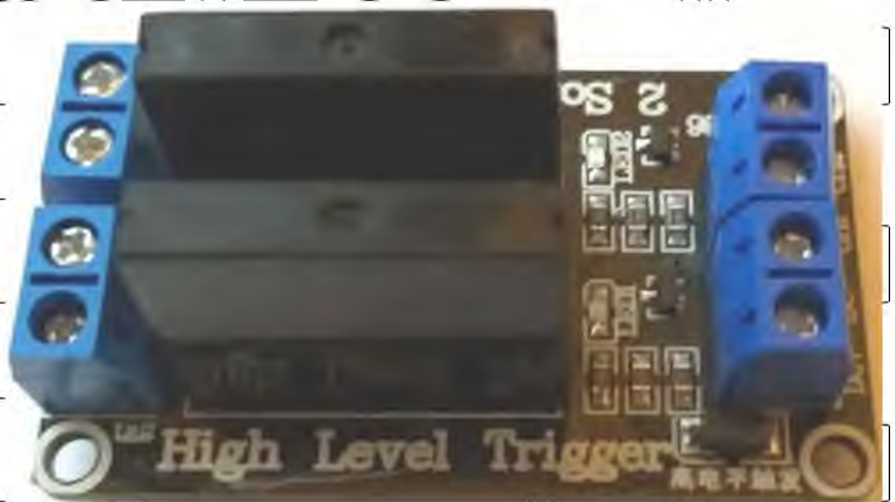
Рис.4.10. Твердотільне реле G3MB-202P.
