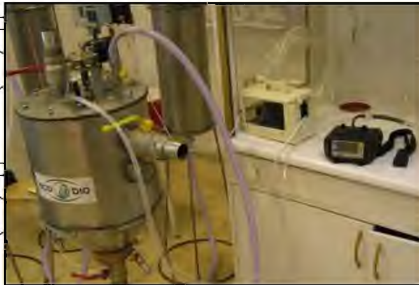
Рис. 2.4. Загальний вигляд лабораторного обладнання при вимірюваннях біогазової продуктивності субстратів
