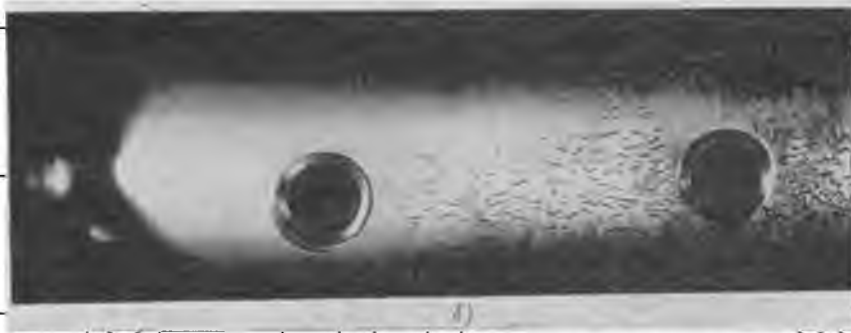
Рис. 2.10. Мікротріщини на шатунній шийці в зоні, відповідній роз'єму штампів
