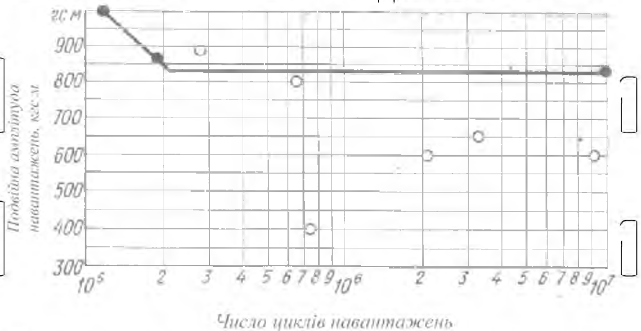
Рис. 2.5. Втомна міцність колінчастих валів зі сталі 50Г, полішених в пісковці, але без зміцнення галтелів роликками (діаметр корінних і шатунних шийок відповідно 105 і 85 мм):
