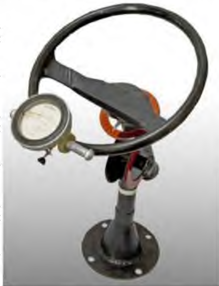
Рисунок 4.6 - Стелд для експериментальної перевірки з приладом ДЛ-01А, приєднаним до обода рульового колеса
