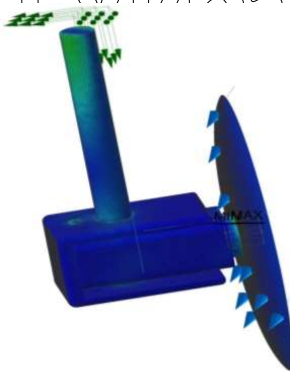
Рис.5.4 Еквівалентне напруження по Мізесу
