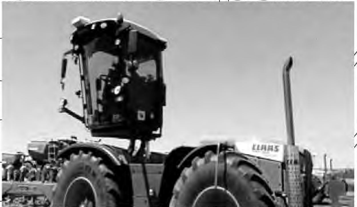
Рис. 2.13. Процес переставлення кабіни енергозасобу типу CLAAS XERION 3800VC
