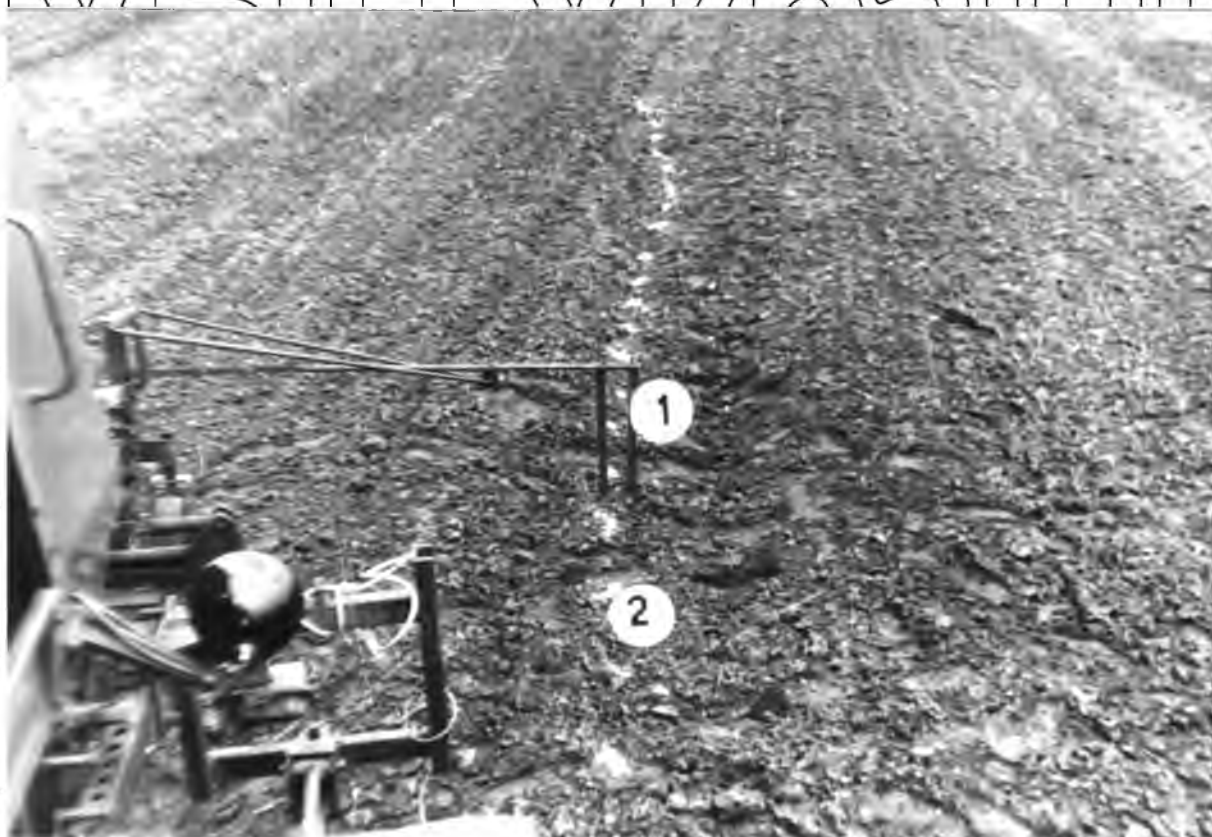
Рис. 3.3. Схема орієнтування водія дослідного просапного агрегату вздовж опорної траєкторії:
