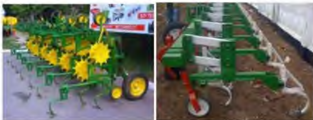
Малюнок 1.16 – Просапні культиватори з паралелограмною підвіскою і пружними S-подібними стійками
