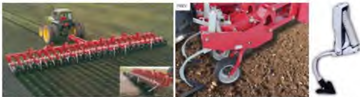
Малюнок 1.14 – Загальний вигляд культиватора для міжрядкової обробки посівів цукрового буряка і технічних культур Wil-Rich PT7722
