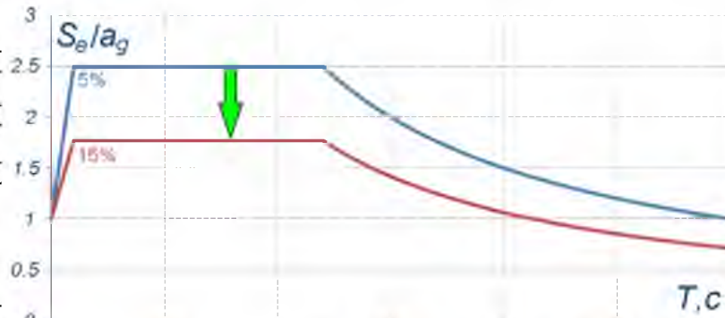
Рис. А.2 - Другий принцип сейсмоізоляції: збільшення відносного демпфування зменшує прискорення та сейсмічні навантаження
