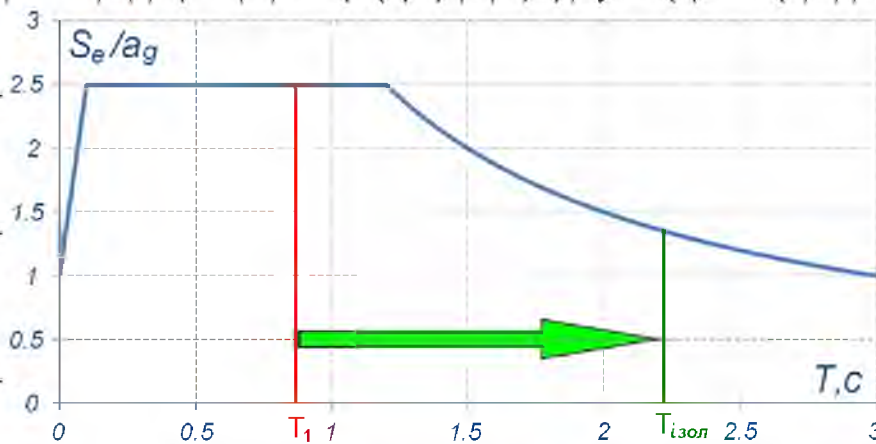
Рис. А.1 - Перший принцип сейсмоізоляції: збільшення періоду коливань будівлі зменшує прискорення та сейсмічні навантаження
