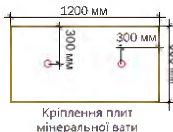
Рис. 3.2. Схема кріплення теплоізоляційних плит з мінеральної вати
