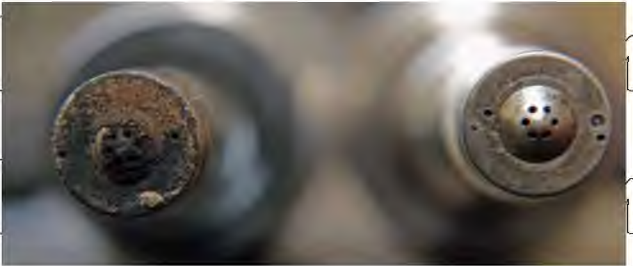
а – розпилювач до очищення; б – розпилювач після очищення безрозбірним методом
