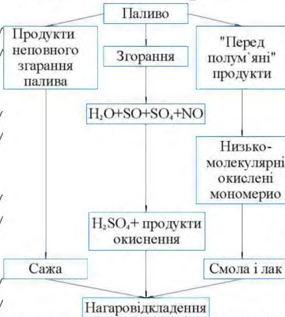
Рисунок 1.1 - Схема утворення нагаровідкладень у дизельному двигуні.
