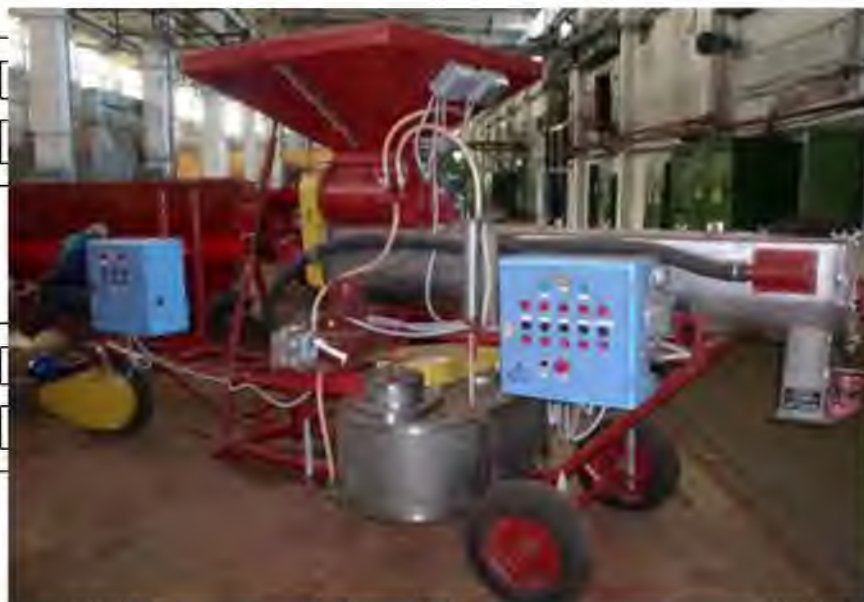
Рис. 1.3. Установка передпосівного протруєння насіннєвого матеріалу УПС-10 [25]
