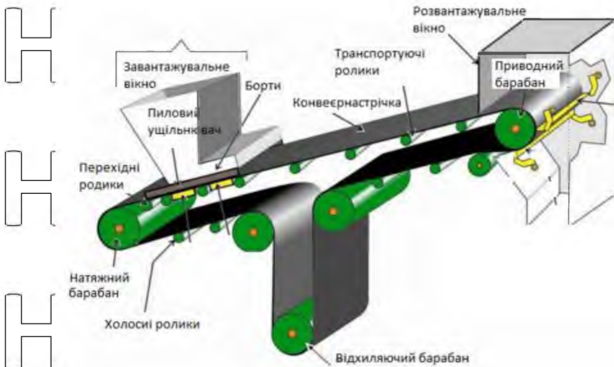
Рис. 1.6. Будова стрічкового конвеєра
