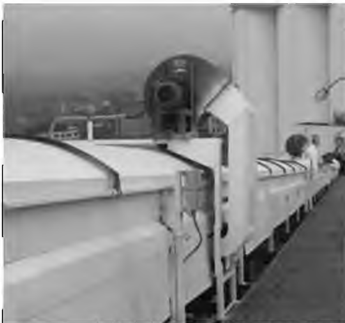
Рис. 1.17. Конвеєр стрічковий на повітряній подушці (Китай), система навантаження зерна часником з продуктивністю 500 т / год
