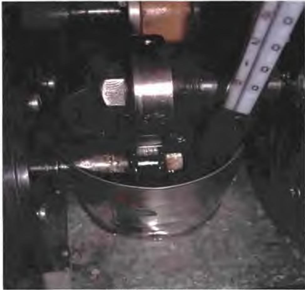
Рисунок 4.2 - Встановлення зразка в на машині тертя під час проведення випробування
