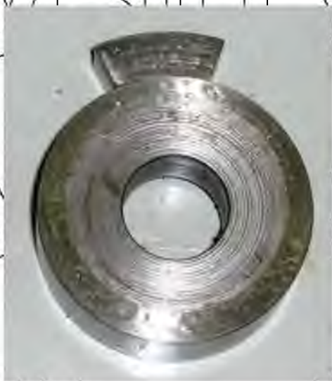
Рисунок 2.7 - Загальний вид зразків: а - ролик; б - колодка
