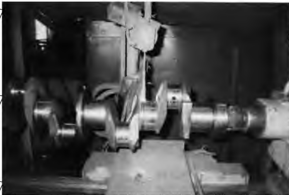
Рис. 3.6 Попередній підігрів шийки колінчастого валу.
