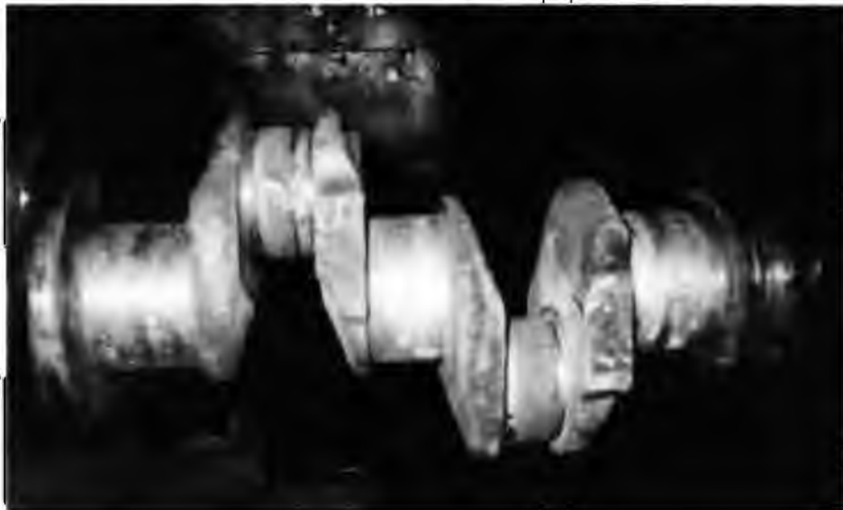
Рис. 4.4. Наплавлені шийки колінчастого валу
