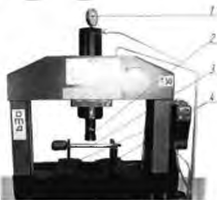
Рис. 5.2. Усування зігнутості штоку на електрогідравлічному пресі марки ОМА 665: 1 – манометр; 2 – упор гідроциліндра пресу; 3 – шток; 4 – призми
