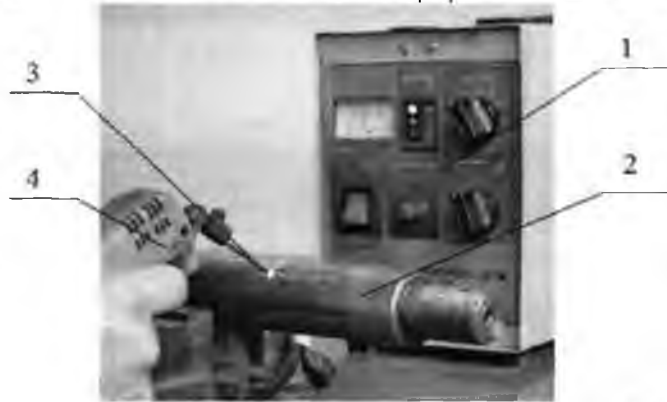
Рис. 5.3. Усунення дефектів на поверхні штока (плунжера) методом ЕЮ: 1 – установка БІГ – 4 ; 2 – шток; 3 – електрод, 4 – вібратор
