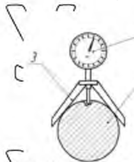
Рис. 3.7. Схема вимірювання глибини дефектів на поверхні штока:
