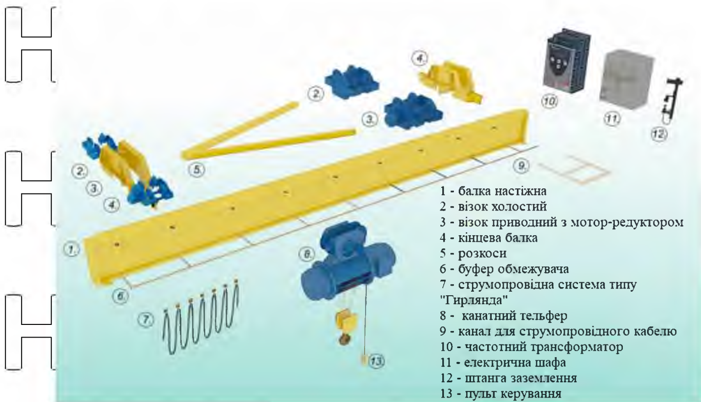
Рисунок 3.1 Підвісна кран-балка
