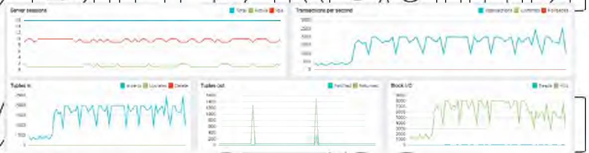
Рис. 4.3.5 Навантаження при тестуванні Kafka
