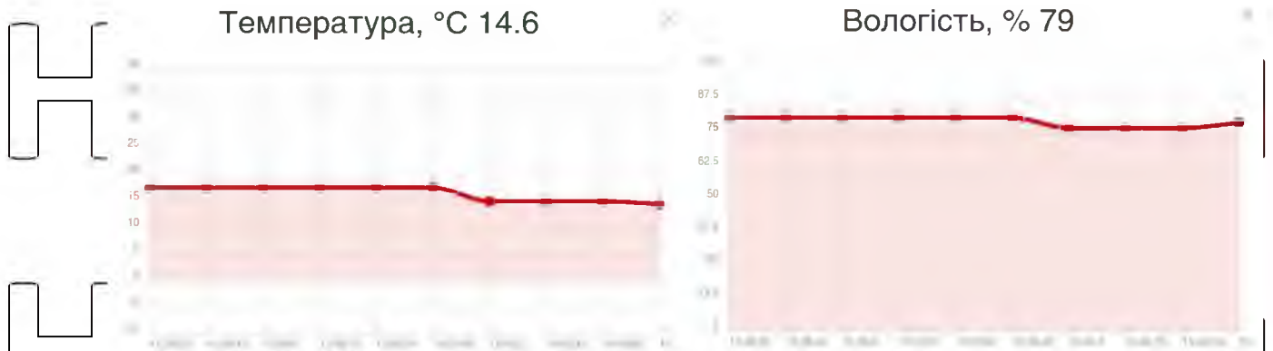
Рис. 3.38 Результати заміру датчиком DHT11
