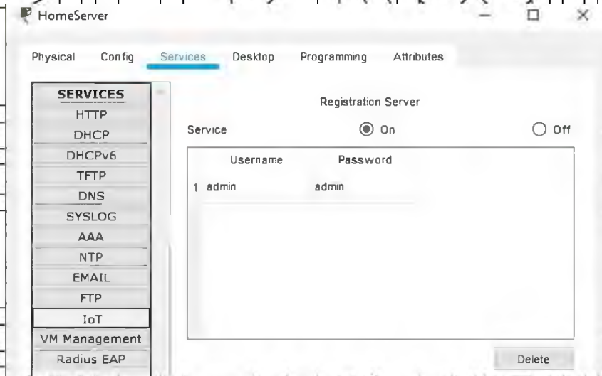
Рисунок 3.16 - Налаштування серверу для підтримки IoT пристроїв
