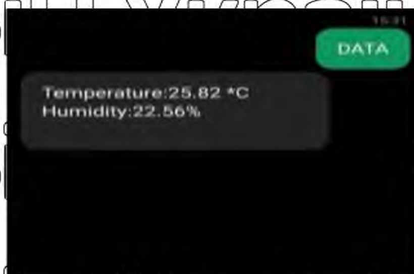
Рисунок 4.7 – Запит та відправка SMS на телефон з параметрами мікроклімату
