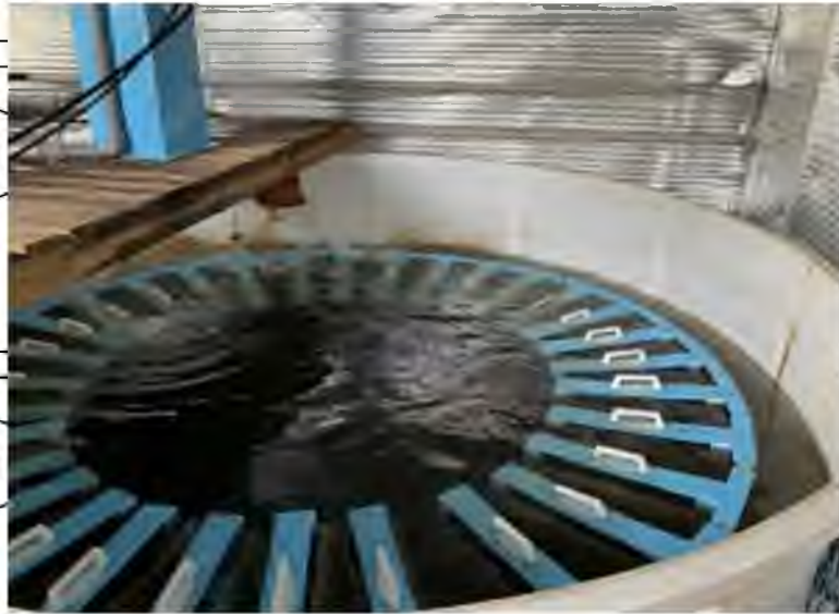
Рис. 8. Обертовий біофільтр з використанням біоблоків.
