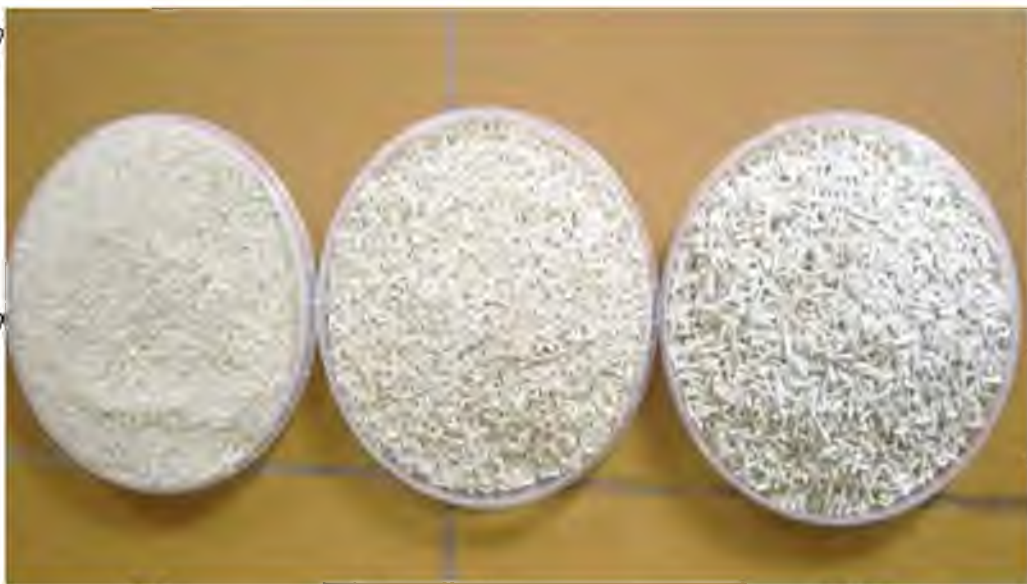
Рис. 3.7. Зовнішній вигляд (3 фракції) лускатих голок, одержуваних з луски в процесі її сухого очищення.
