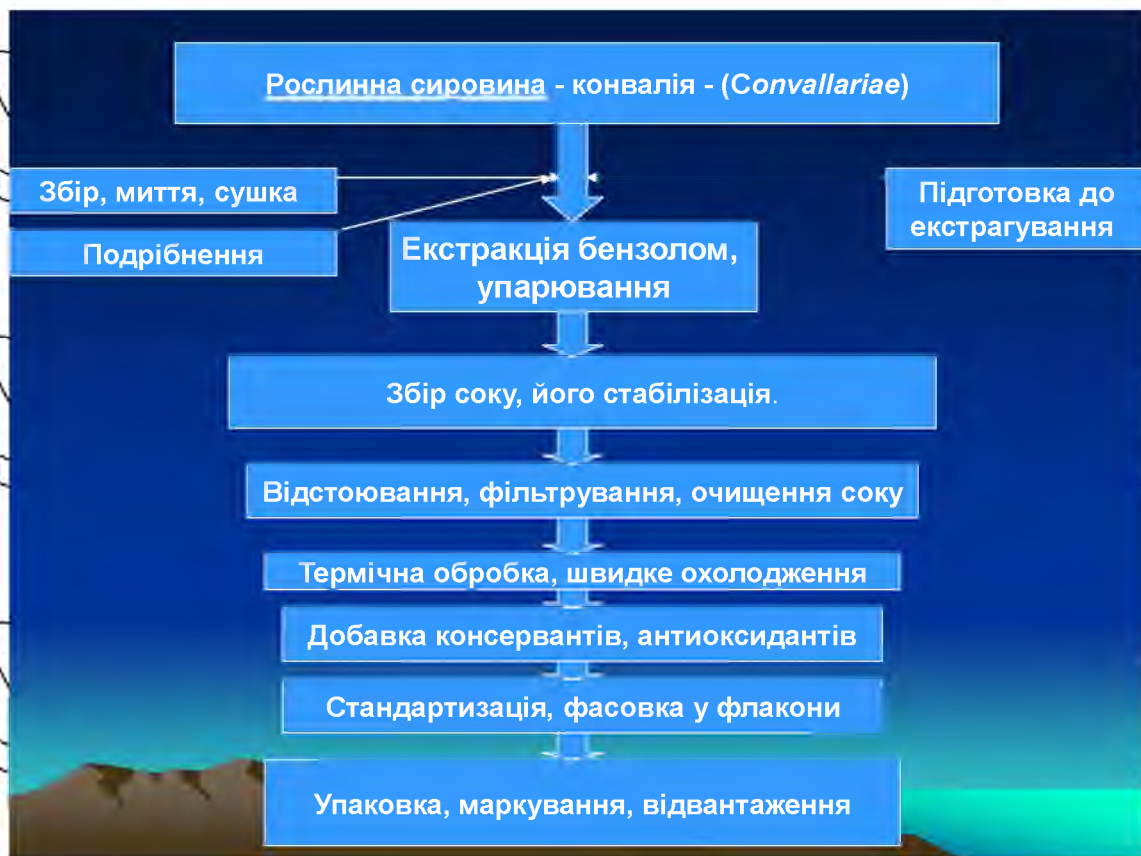
Рис. 3.2 Блок-схема технологічного процесу одержання соку з свіжої сировини.
