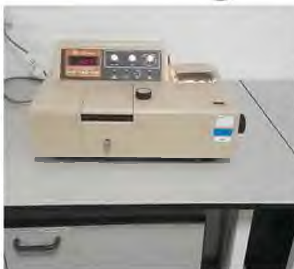
Рис. 4.2. Спектрофотометр Varian 634 S у лабораторії ВАТ «Бровар», за допомогою якого визначали концентрацію діацетилю в суслі.
