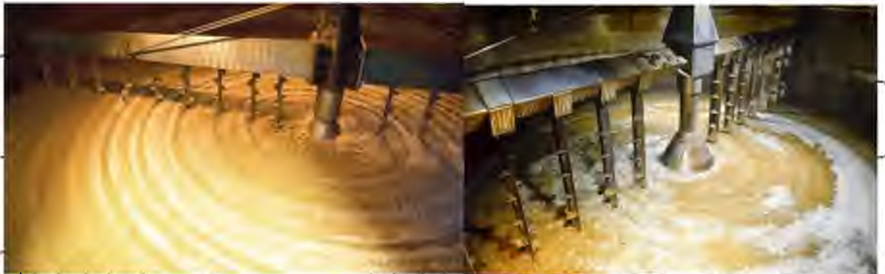
Рис. 2.2. Процес подрібнення, кип'ятіння і затирання солоду на підприємстві ВАТ «Бровар».
