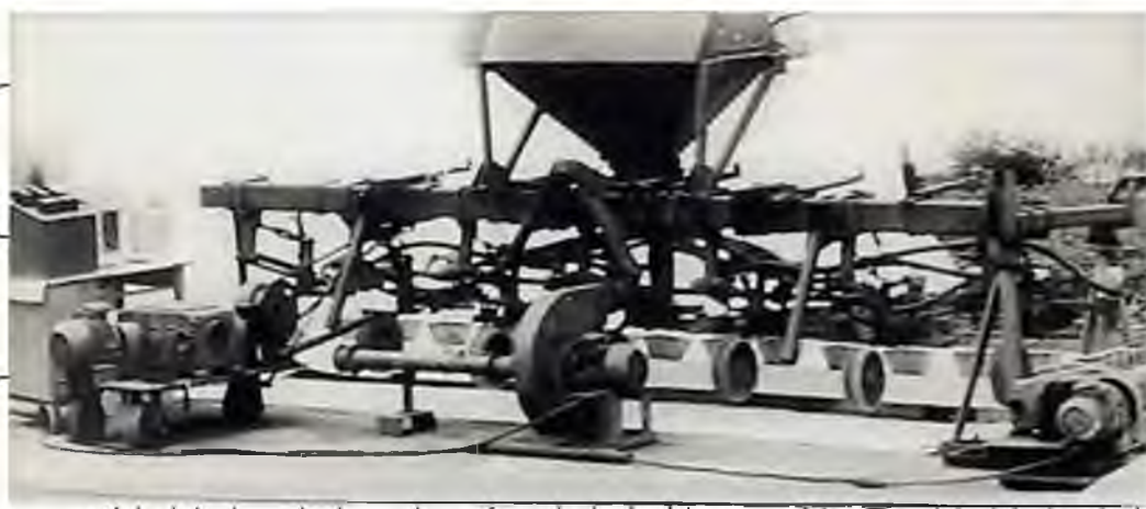
Рис. 3.7. Загальний вигляд лабораторної установки для дослідження процесу висіву добрив багатоканальною висівною системою
