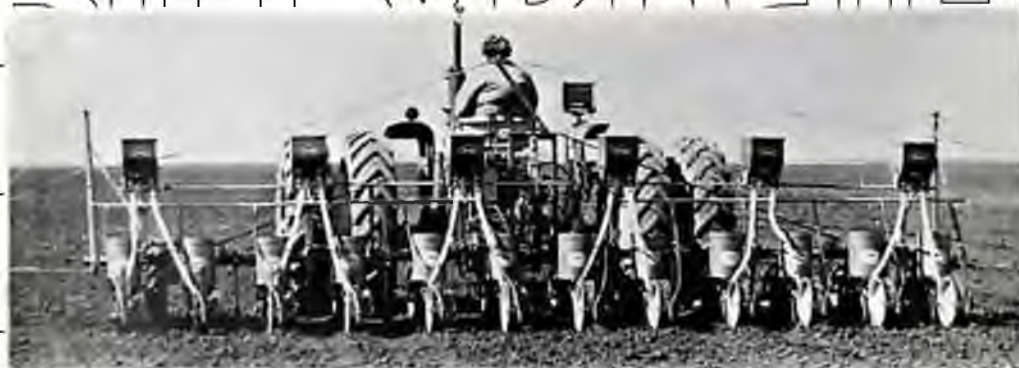
Рис. 1.2 загальний вигляд сійки з індивідуальним туковисівними апаратами
