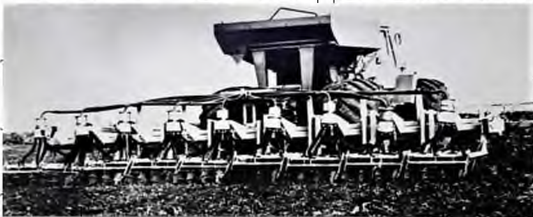
Рис. 1.4 загальний вигляд агрегату АВМ-8 для внутрішньогрунтового внесення основної дози мінеральних добрив
