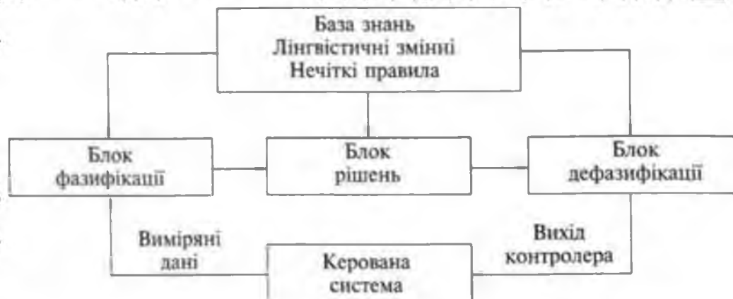
Рис. 4.1. Схема роботи нечіткого регулятора
