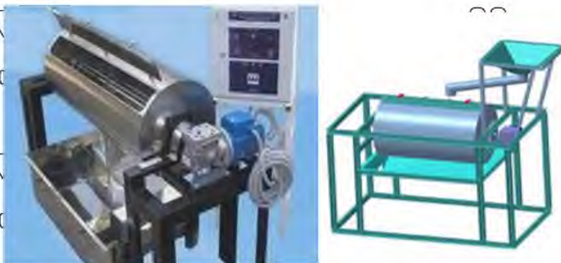
Рис. 1.5. Установка СН -100УФ для передпосівної обробки насіння а- загальний вигляд; б- схематичний вигляд.
