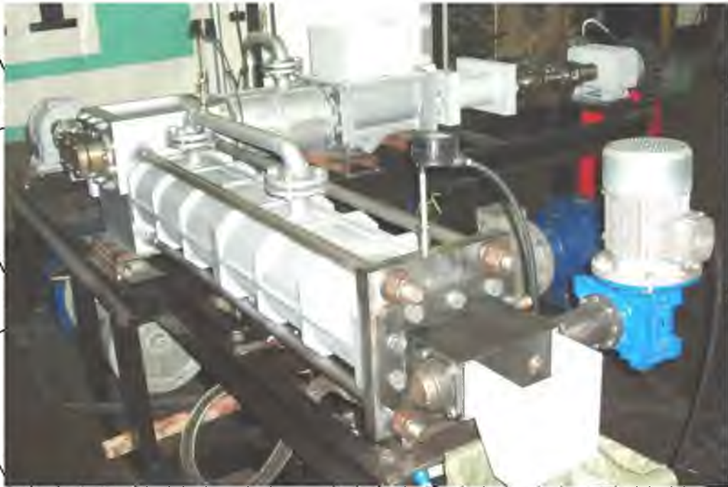
Рис. 1.2. Установка високотемпературного гідролізу пухо-пір'яної сировини у тонкому шарі
