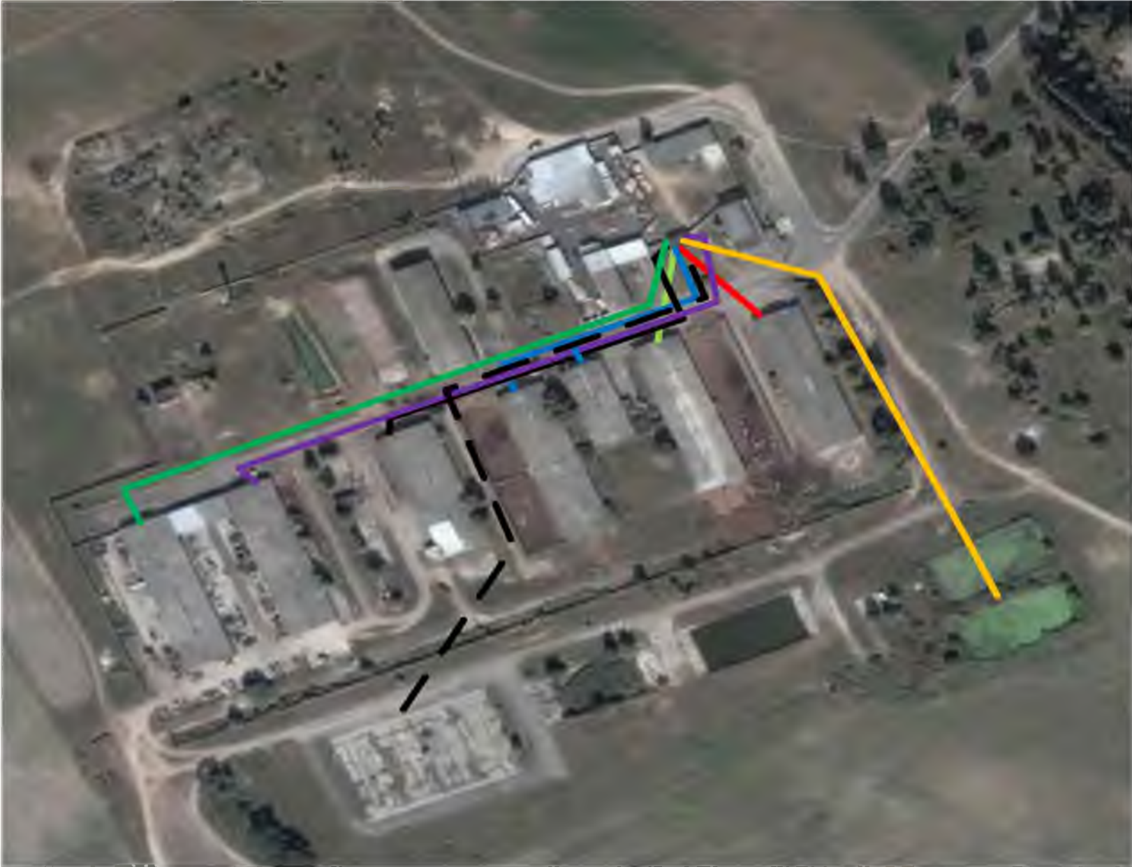
Рисунок 1.3 - Схема електропостачання господарства НДГ від ТП №207
