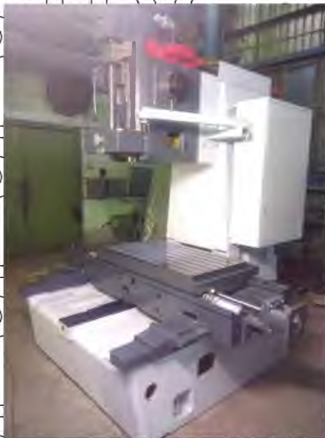
Рис. 2.5. Двошпиндельний розточувальний верстат зі спеціальними різцевими головками
