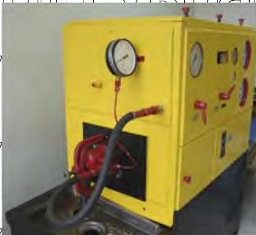
Рис. 3.5. Стенд для прискорених ресурсних випробувань НШ
