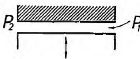
Щілина з нерухомої стінки та лопаті, що переміщується
