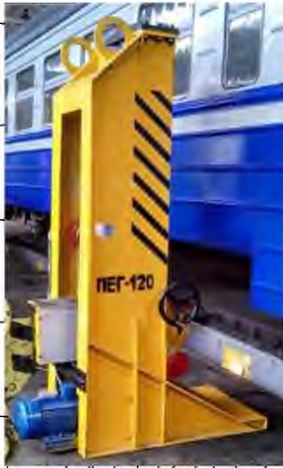
Рис. 1.6. Гвинтовий підйомник ПЕГ-120
