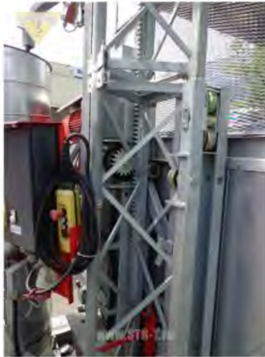
Рис. 1.8. Рейковий механізм ліфта
