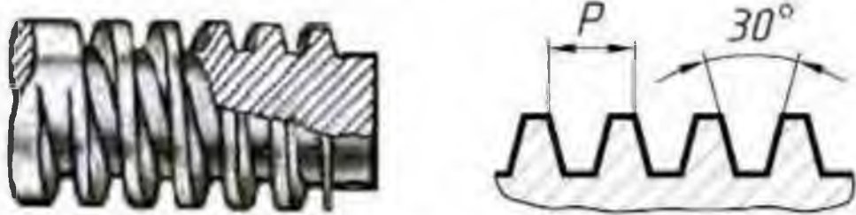
Рис.1.9. Профіль трапецеїдальної різь
