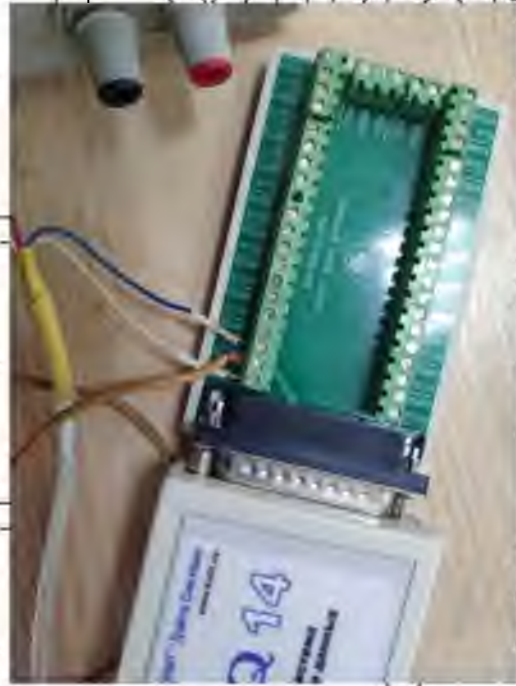
Рисунок 4.2 – Підключення датчика до системи електропостачання та до mDaq
