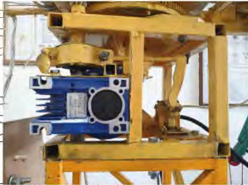
Рисунок 3.2 Деталі механізму повороту моделі баштового крану
