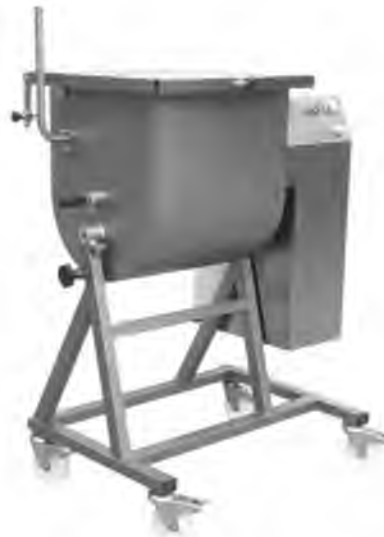
Рис. 1.3. Фаршмішалка С/Е ММ25
