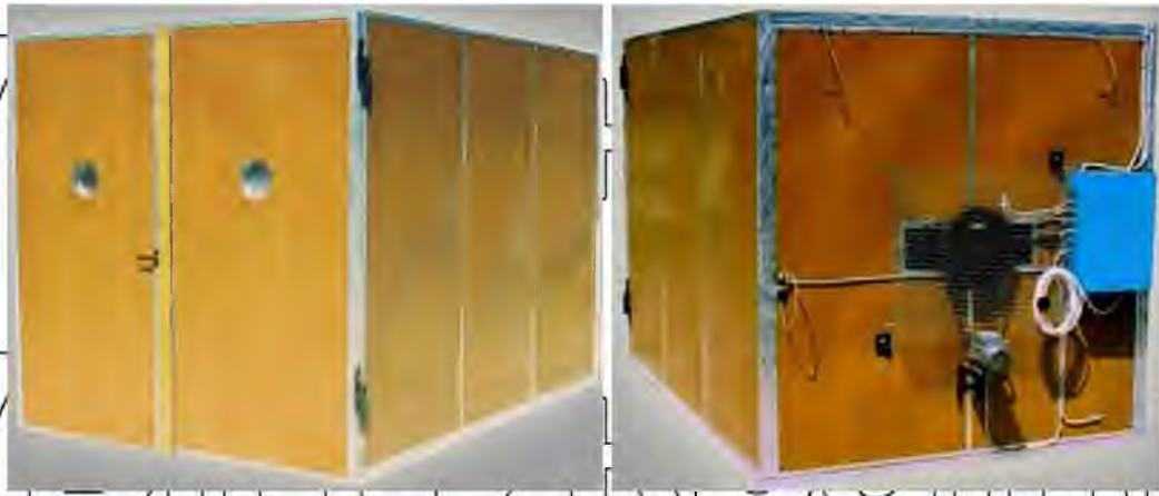
Рис. 1.7. Інкубатор попередньої інкубації на 16000 яєць ИНКИ-16000
