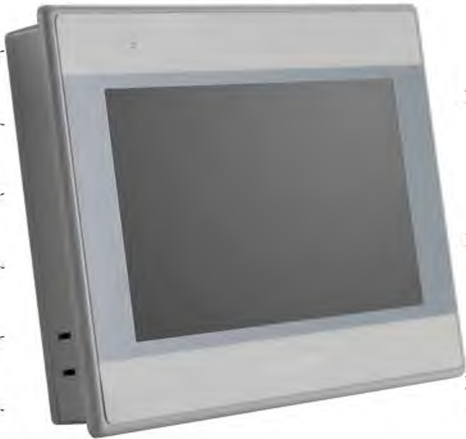
Рис. 4.7 Зовнішній вигляд панелі оператора Weintek MT8071iE, 7"
