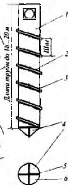
Рис. 5.5. Схема буро-загвинчуваної палі: 1 - металева труба; 2 - зварка навивки з трубою; 3 - навивка з арматури діаметром 10-16 мм з кроком 200... 400 мм; 4 - хрестовидний глухий наконечник; 5 - хрестовини; 6 - диск з металу
