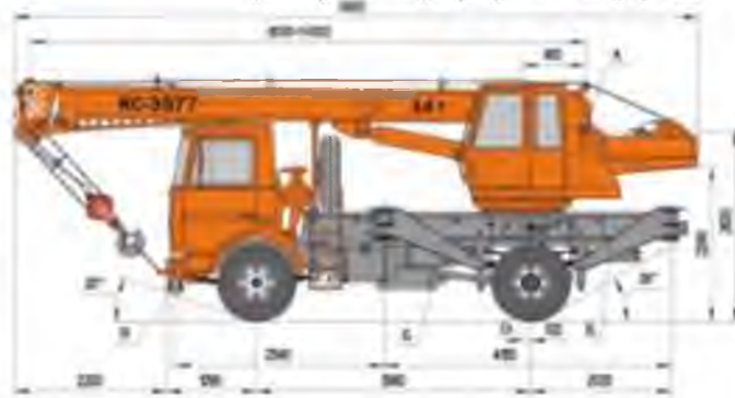
Рис. 5.6. Загальний вигляд пневмоколісного стрілового крану КС-3577
