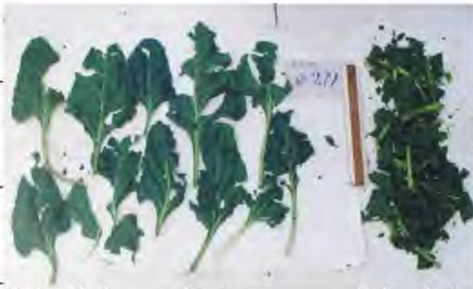
Рис. 3.18. – Пучки ботвиння, які зазнали дії лопатей різних типів, при кутовій швидкості робочих органів \omega_{\text{роз}} = 57 \text{ с}^{-1} : а, б, в і г – відповідно лопатей типу А, Б, В і
