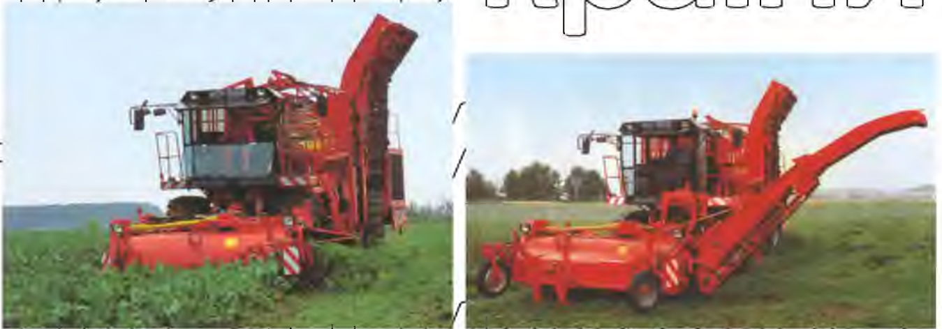
Рис. 1.14. Варіанти комплектації модуля для видалення ботвиння з головок коренеплодів комбайна Terra Dos виробництва компанії Holmer
