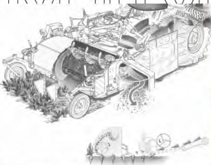
Рис. 1.13. Конструкційно-технологічна схема модуля для видалення ботвиння з головок коренеплодів комбайна Rora Euro Tiger
