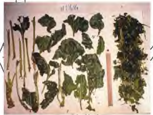
Рис. 3.18. – Пучки ботвиння, які зазнали дії лопатей різних типів, при кутовій швидкості робочих органів \omega_{\text{роз}} = 57 \text{ с}^{-1} : а, б, в і г – відповідно лопатей типу А, Б, В і
