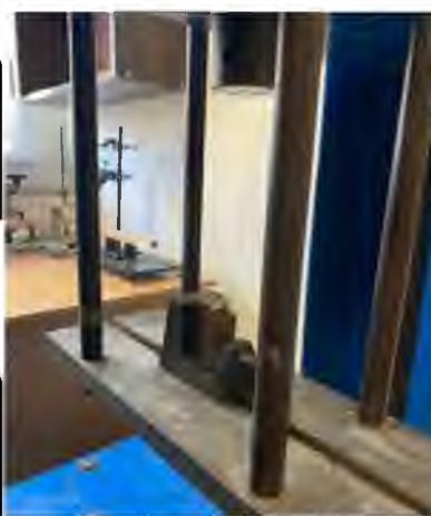
Рис.4.3 Розміщення взірця в розривній машині
