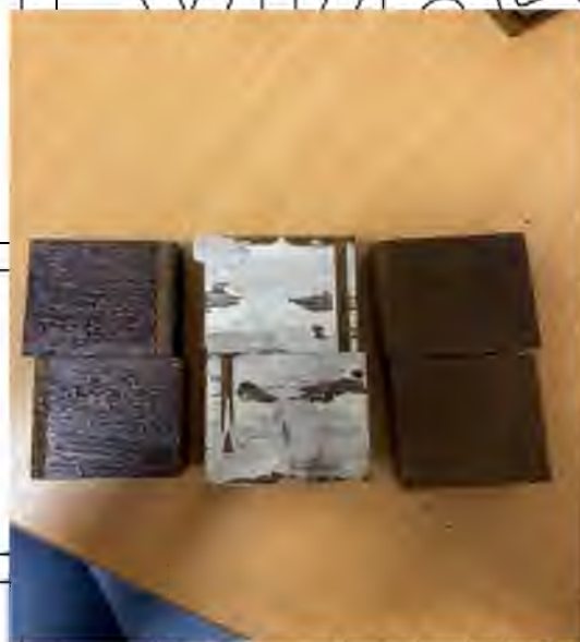
Рис.4.4 Пошкодження клейового з'єднання зразків після роботи на розривній машині
