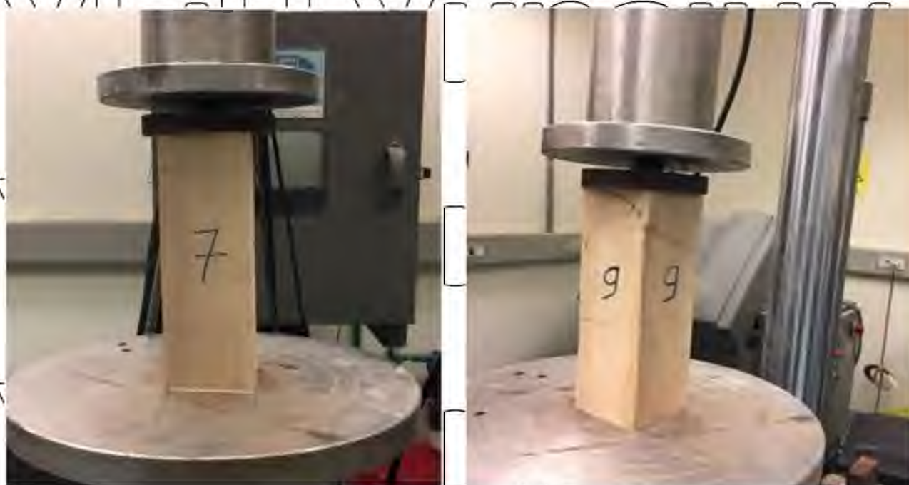
Рис. 3.3. Випробування зразків на стиск уздовж волокон
