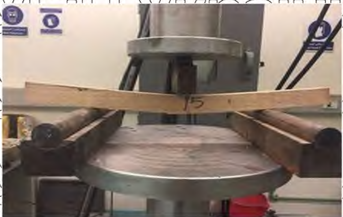
Рис. 3.5. Випробування зразків на статичний згин
