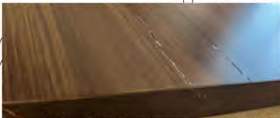
Рис. 1.11 Вигляд тріщини на виробі з деревини [23]
