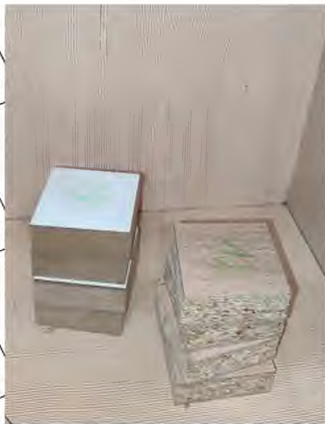
Рис. 3.6 Зразки ДСП та MDF
