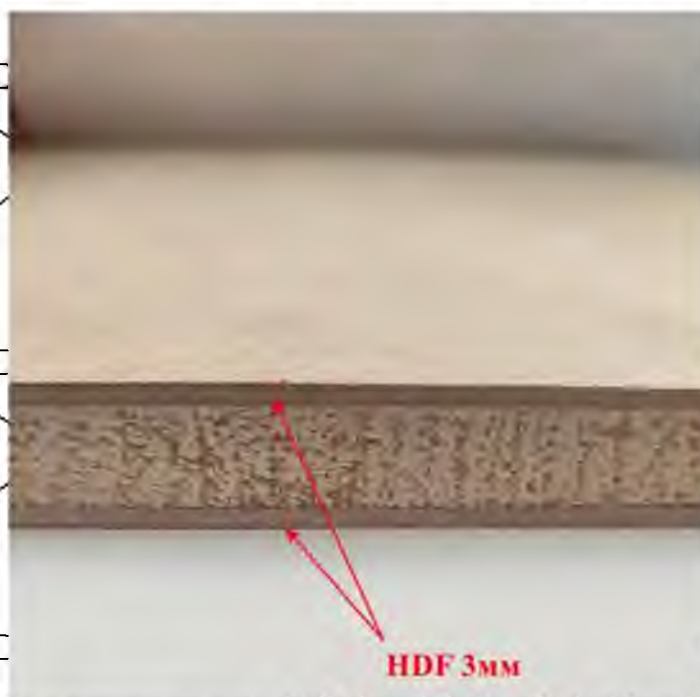
Рис. 1.5 Видгляд плити HDF використаної в меблевому щиті
