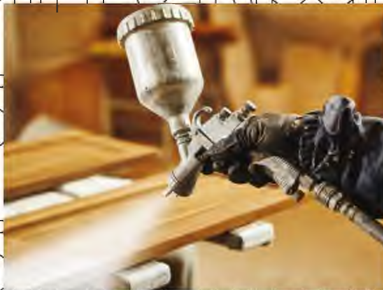
Рис. 1.11. Пневматичне розпилення лаку [3]
