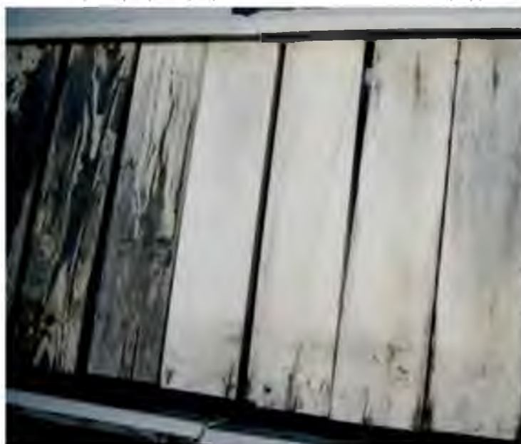
Рис. 3.1. Ефективність панелей з ацетилюваним покриттям після 13 років впливу [19]
