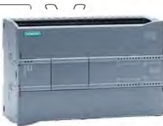
Рис. 3.10. (6ES7217-1AG40-0XB0) Програмований контролер серії SIMATIC
