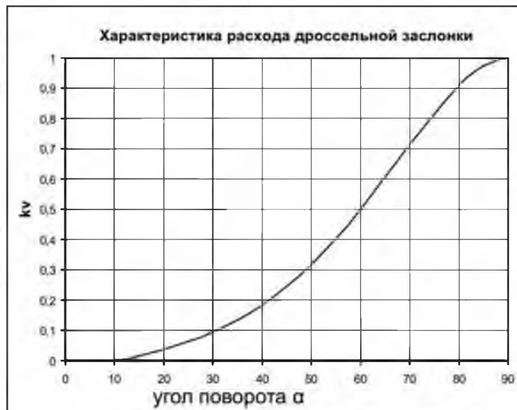
Рис.3.7. Залежність коефіцієнта витрати k_v = K_v / K_{vs} від кута повороту диска дросельної заслінки
