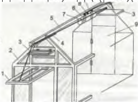
Рис. 1.3. Схема пристрою автоматичної системи провітрювання теплиці: 1 – нижня фрамуга; 2 – каркас; 3 – верхні фрамуги; 4 – гнучка тяга нижній фрамуги; 5 – тяга гнучка; 6 – гідравлічний циліндр; 7 – кронштейн; 8 – блоки; 9 – двері
