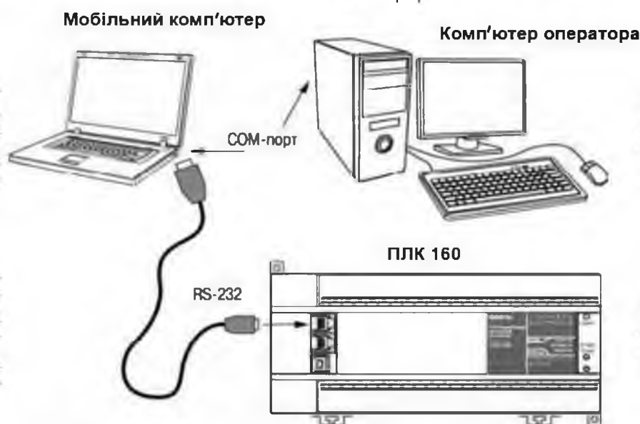
Рисунок 4.9. Підключення контролера до ПК для програмування
