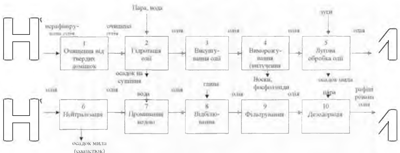
Рис. 1.1. Технологічна схема рафінації олії
