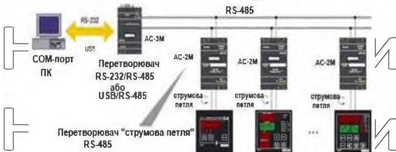
Рис. 4.2. Схема підключення пристроїв з інтерфейсом "струмова петля" до ПК через перетворювачі ОВЕН АС2, ОВЕН АС3-М
