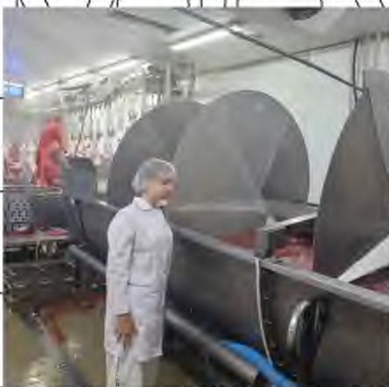
Рис. 3.4. Потрапляння тушки у шнекову ванну охолодження з льодом
