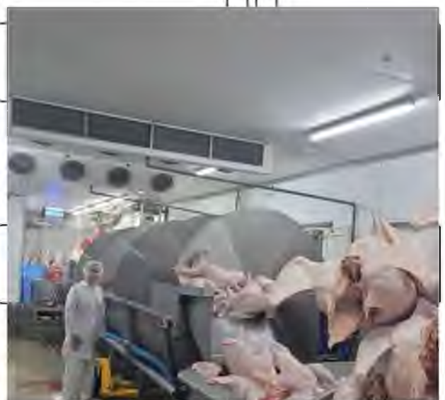
Рис. 3.4. Потрапляння тушки у шнекову ванну охолодження з льодом
