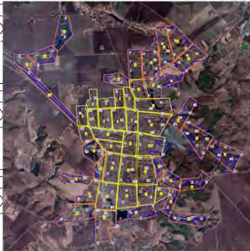
Рис. 17. Схема проєкту польотів та опознаків (власний знімок екрану)
